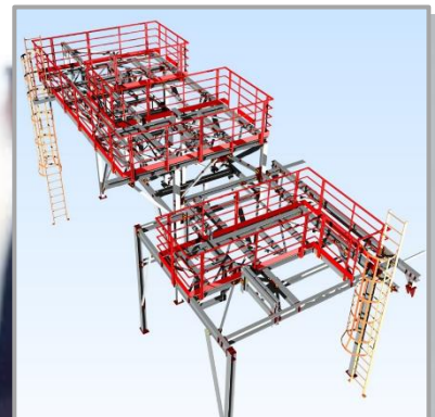
Čelična konstrukcija za rafinerije s platformama, ljestvama i ogradama i ukrasnim elementima.
