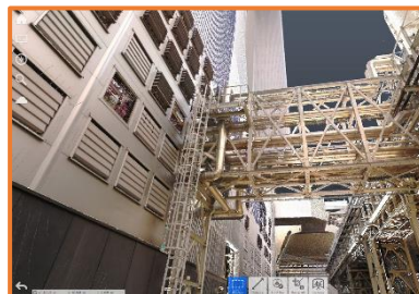
3D oblak točaka mosta preko cijevi. 3D prikaz 02a.
