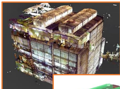
3D-Modell des Gebäudes inkl. As-Built Stand mit Modifikationen.
