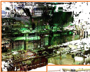
Registrirani oblak točaka laserskog skeniranja. Opseg od 30 snimaka.
