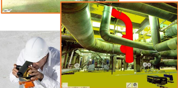
Povezivanje modela cjevovoda s postojećim sustavom u fotorealističnom kontekstu. Snimanje stvarnosti omogućuje detaljnu provjeru kolizije.
